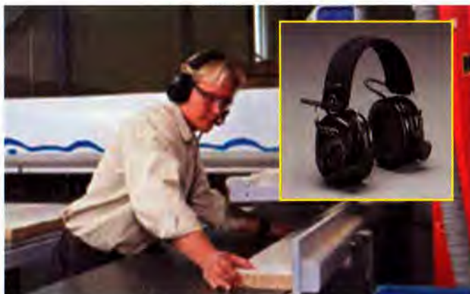
אוזניות טקטיות, בעלות מיקרופונים קדמיים לקליטת רעשי הסביבה. אלה מאפשרים להגביר את עוצמת השמיעה של הקולות מהסביבה בהתאם לצרכים מיוחדים
