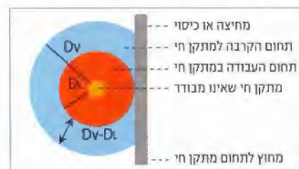
איור 2: תחום העבודה ותחום הקרבה למתקן חי לאחר התקנת מחיצה או כיסוי במרחק מתאים ממוליך חי, בהתאם למתח במתקן ועל פי הכתוב בתוספת הראשונה לתקנות
