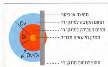
איור 3: תחום העבודה ותחום הקרבה למתקן חי לאחר התקנת מחיצה או כיסוי במרחק קטן ממוליך חי, בהתאם למתח במתקן ועל פי הכתוב בתוספת הראשונה לתקנות
