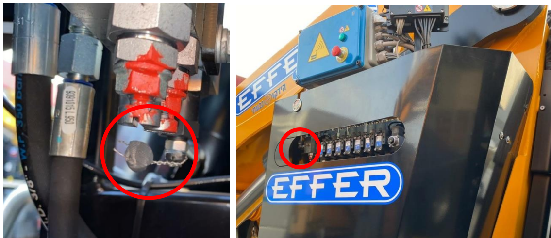
בורר ראשי (סלקטור) הכולל פורק לחץ (עם חותם) בעגורן תוצרת EFFER (מסומן בעיגול אדום)
