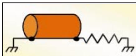
איור 50: הארקה של גוף חם עם נגד טורי של 1 מגה אוהם ( M\Omega )
