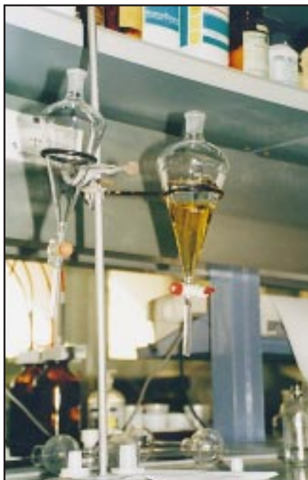
משפכים מפרידים מונחים על גבי טבעות משען
