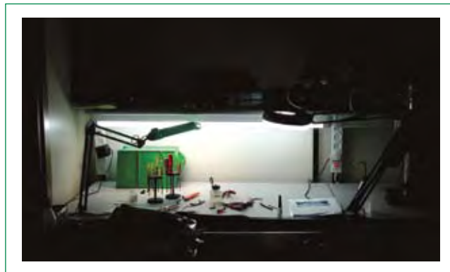
איור 6: תאורה לא אחידה: עוצמת אור גדולה וחזקה על מישטח עבודה וחלשה מסביבו
