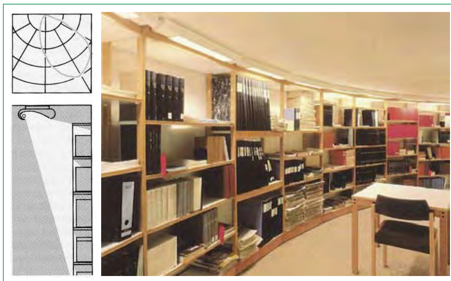
איור 57: תאורה בספרייה ודוגמה לעקום פיזור האור של גוף תאורה להארה אנכית
