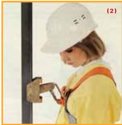
(2) חיבור בין בולם נפילה מונחה על קו עיגון אנכי מפרופיל קשיח לבין נקודת צימוד קדמית ברמתה. (ראו הערה בדוגמה 1).
