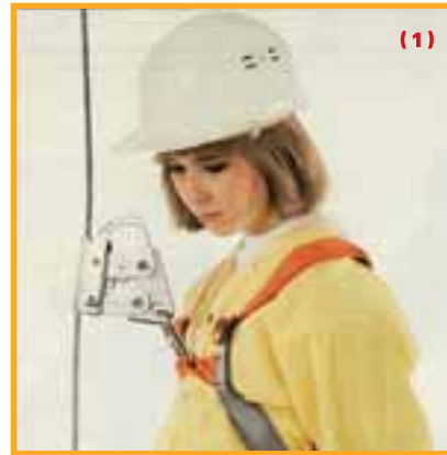
(1) חיבור בין בולם נפילה מונחה על קו עיגון מכלל פלדה לבין נקודת צימוד בחלק הקדמי של רתמה, במרכז החזה. הערה: נקודת צימוד קדמית נדרשת, ע"פ תקנות הבטיחות לעבודה בגובה, ברמות המשמשות לטיפוס על תרנים, שצריכות להיות גם משולבות במערכות מיקום תמיכה.
