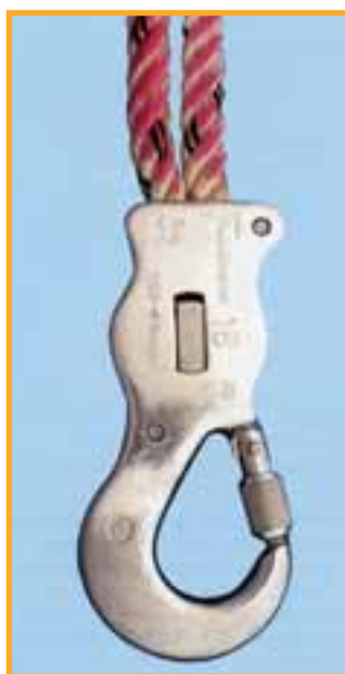
איור 24: אנקול בטיחות מטיפוס קרבינר (karabiner) אנקול הבטיחות הזה מצויד בלשונית קפיצית, הנפתחת בלחיצה עליה ונסגרת מעצמה כשהלחיצה נפסקת. הלשונית מצוידת בבורג נעילה. לכן, פתיחת האנקול כרוכה בביצוע 2 פעולות רצוניות: פתיחת הבורג ולחיצה על הלשונית, כנדרש בתקן (ת"י 1849 חלק 9). אנקול בטיחות זה הוא מהסוג "נסגר מאליו וננעל ידנית".
