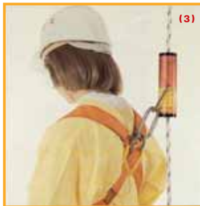
(3) חיבור בין בולם נפילה מגובה בצורת גליל, המותקן על קו עיגון אנכי מחבל סינטטי, לבין נקודת צימוד בצידה האחורי של הרתמה, במרכז הגב.
