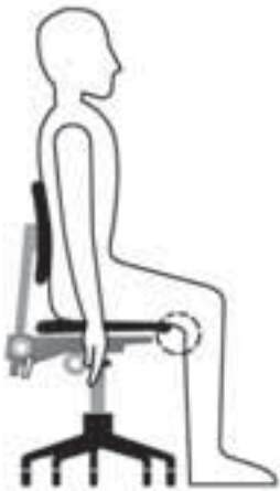
איור 16: המירווח בין הקצה הקדמי של המושב לבין הרגליים הוא כגודל אגרוף קפוץ (כ-5 ס"מ)
