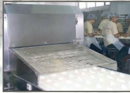
מיגון עם מגן גבול למניעת החדרת ידיים לאזור סכיני חיתוך הבצק על הסרט הנע. המכונה נעצרת אוטומטית ברגע שהמגן מורם ממקומו
