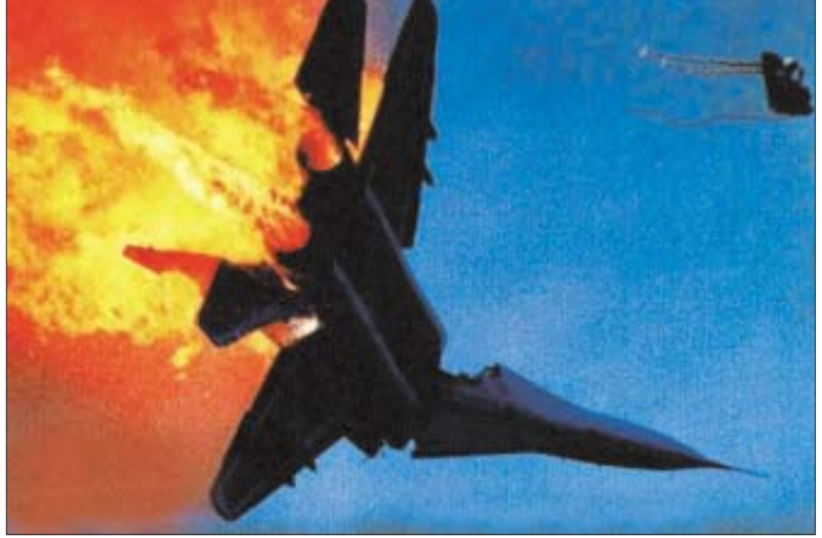
תמונה 1: דוגמה למנגנון ייעודי לבטיחות - כסא-מפלט במטוס קרב
