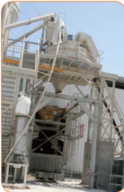
▲ מיתקן הכנת תערובת הבטון. בתהליך ייצור מיוחד הבטון מתמזק והחלק מוצא מתוך תבנית היציקה בתוך 6 שעות
