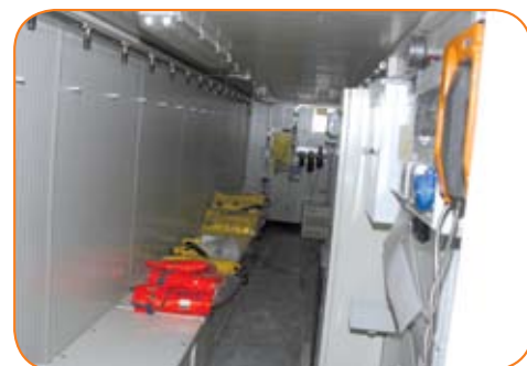
▲ תא מילוט עמיד באש. חלק ממערך המוכנות למצבי חירום במכונת ה-TBM הוא קרון / תא עמיד אש למשך 120 דקות אשר יכול לאכלס 15-20 איש. בתוך הקרון מערכות אספקת אוויר לנשימה, גלאי אשר בודק באופן רציף קיום של מזהמים באוויר, וטלפון לתקשורת עם מוקד הנמצא מחוץ למנהרה
